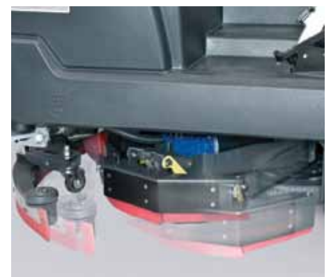
Grupo de escovas pivotante e lábios com desacoplamento rápido que evita danos no caso de embater em algum obstáculo.
